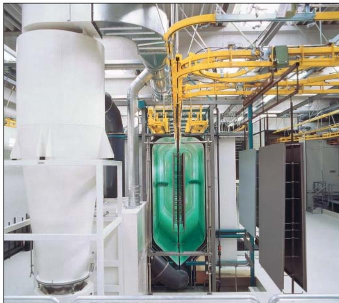
Cabina di verniciatura con sistema rapido per cambio colore
